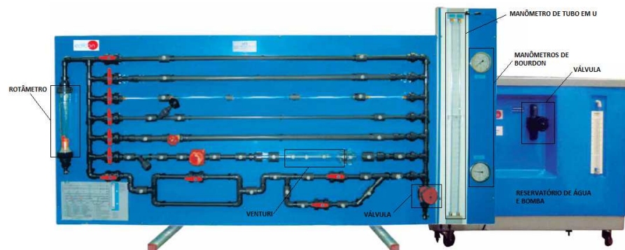
Figura 1 – Bancada experimental para estudo de perda de carga da Edibon. Fonte: Edibon (2012).
