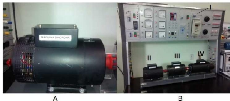
**Figura 3.1:** (a) Motor síncrono utilizado nos ensaios em detalhe. (b) Bancada didática de máquinas elétricas do LABCE, onde pode ser visualizado o painel de controle (I), o motor síncrono (II), o motor assíncrono (III) e o motor de corrente contínua (IV).
