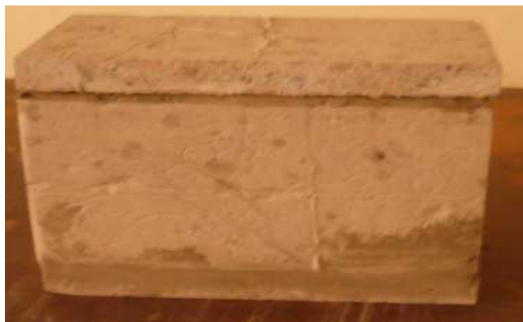
Figura 6 – Caixa de concreto leve utilizada no ensaio de acústica.
