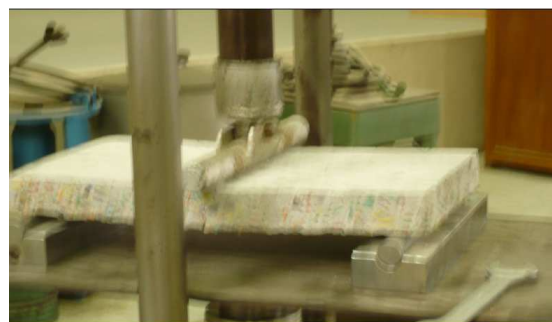
Figura 5 – Execução de ensaio de Flexão.
